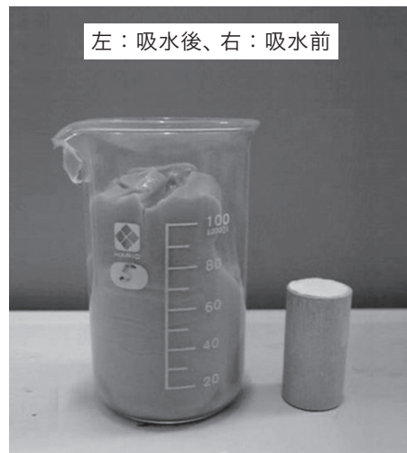
図4 ベントナイトの膨潤挙動と高レベル放射性廃棄物地層処分施設の概要
