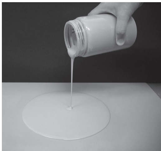
図1 超重泥水(左:写真は、NB研/ホージュン/早大地盤研の氏家伸介氏提供)と技術研究組合国際廃炉研究開発機構(IRID)プロジェクトへの貢献(右)( https://www.nb-institute.com/nb%e6%8a%80%e8%11%93%e7%b4%b9%e4%bb%8b/nbc/ )
